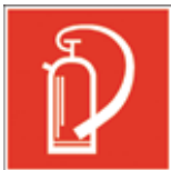
Brandschutzzeichen F04 „Feuerlöschgerät“ nach GUV-V A8
